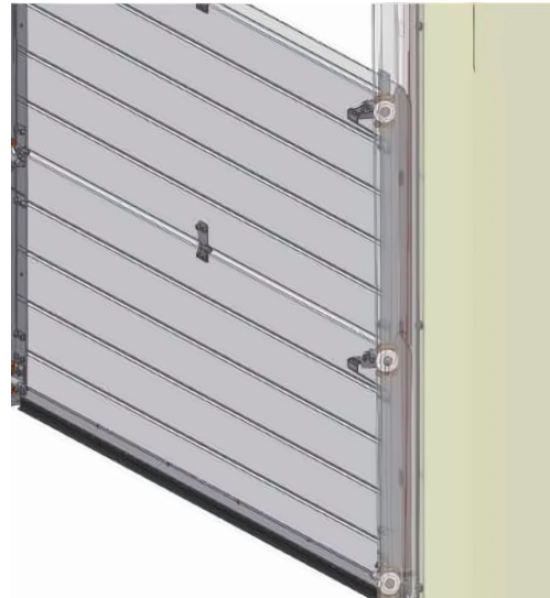
Traseul cablului pe înălțimea ușii.
